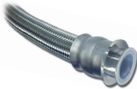
内面が山状のPTFE製のライナーとフレアの一体化、PTFE製のフレア部はシール用の形にするために熱間成型されています。
