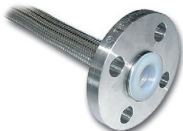
ラップジョイントタイプでフランジはルーズ、内面が山状のPTFE製のライナーとフレアの一体化構造。
