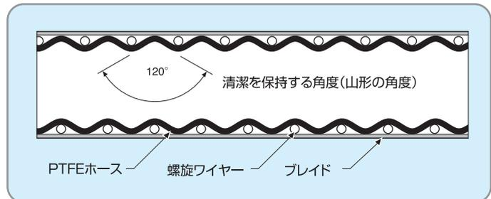
■ 高温・高圧下でねじれに強く、真空耐性があるのは、市場の山状PTFEホースの中でコロフロンだけです。これは外側を太いワイヤーで螺旋状に巻いて補強することにより、可撓性と内部の清潔さを保ちながらも、最大限の抵抗力を確保するのに必要な外周方向への支えとなっているからです。螺旋巻きのワイヤーは両端で末端金具に直接ハンダ付けされて固定され、電氣的連続性を確保しています。
