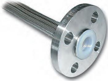
ラップジョイントタイプでフランジはルーズ、内面が山状のPTFE製のライナーとフレアの一体化構造。
