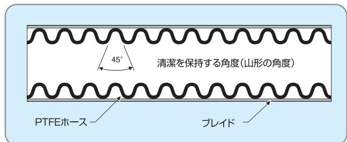
■ 1インチ及びそれ以上のサイズでPTFEホースの壁厚が少なくとも1.5mmを保証できるただ一社のPTFEメーカーです。これにより、チューブ内部がサインウェーブ（正弦波）形から伸びて角ばった波形に変形するのを防ぐことができます。変形は多孔性のチューブを生み出し、ひいてはチューブが早い段階で欠陥を引き起こすこともあります。この壁厚の厚いホースは浸透を少なくともします。末端金具まで延びたフレアーにより、内部の流れが金具の所まで通して妨げられず、液溜まりも起こりません。
