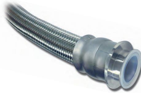
内面が山状のPTFE製のライナーとフレアの一体化、PTFE製のフレア部はシール用の形にするために熱間成型されています。
