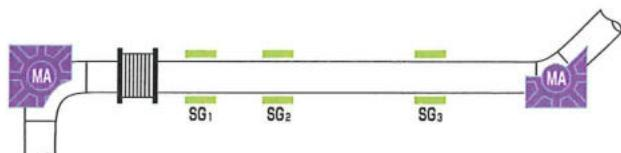
流体圧力、ベローズのバネ反力、その他すべての配管負荷に耐えうる強度を有する固定点です。
