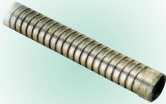
ステンレス(SUS302)使用。過度の曲げ防止外装ケーシングは、ホースの過度の曲がり・ねじれを防止し、ワイヤーブレイドの摩擦を保護します。全長・継手・首元部への応力防止用にこのケーシングをぜひご使用ください。
